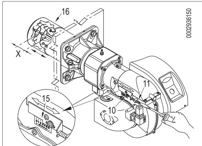
**X** = Расстояние от головки до диска; отрегулируйте расстояние **X**, следуя приведенным ниже указаниям:
